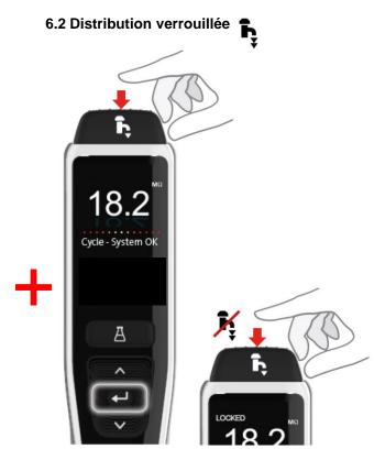
Appuyez sur le bouton de distribution pour régler le débit en fonction de la pression appliquée, puis appuyez sur le bouton Entrée et relâchez-le pour activer la distribution continue. Relâchez le bouton de distribution lorsque « Locked » (Verrouillé) apparaît sur l'écran.
