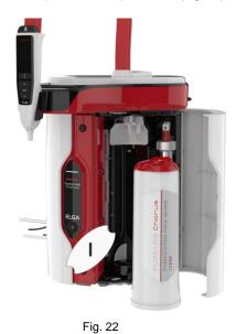
c. Ouvrez la porte de droite, retirez le ruban adhésif de transport sur la poignée du pack en position 1 et sur le pack de dérivation LC233 le cas échéant. (Fig. 22)
