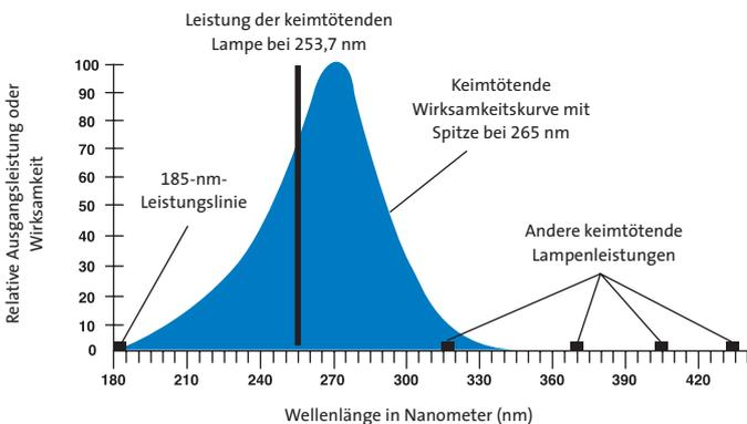
Die keimtötende Wirksamkeit von UV-Licht ist proportional zu Kontakt und Intensität, die normalerweise in  $\mu\text{watt.s/cm}^2$  angegeben wird. Bakterien lassen sich relativ leicht beschädigen, und man benötigt dazu in der Regel eine Bestrahlung mit 3.000 bis 12.000  $\mu\text{watt.s/cm}^2$  zur Deaktivierung von mehr als 99,9% der Population.
