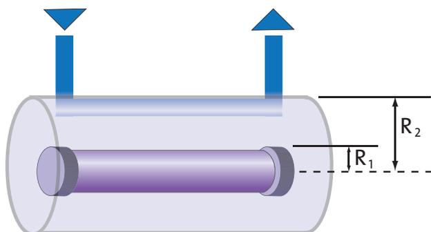
Zur effektiven Ausnutzung der UV-Emission bei 254 nm ist die Lampe von einer durchlässigen Quarzhülle umschlossen, die als Barriere zwischen der Lichtquelle und dem Wasser dient und selbst wiederum von einem Gehäuse aus reflektierendem Edelstahl umgeben ist. Das Wasser strömt im zwischen Quarz und Stahlgehäuse gelegenen Ring.
